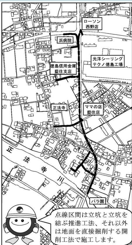
点線区間は立坑と立坑を結ぶ推進工法、それ以外は地面を直接掘削する開削工法で施工します。
