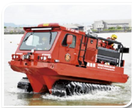
津波や大規模な風水害により浸水した地域や、大規模地震により液状化した悪路でも走行できる機動力を活かして災害で孤立した地域にアプローチし、救出活動や救援物資の搬送等を行います。基本的には、管内で災害対応特殊車両として運用しますが、県外の大規模災害等に緊急消防援助隊(徳島県土砂・風水害機動支援部隊)として応援出動することもあります。
